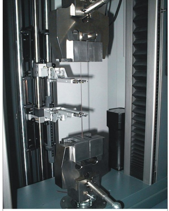
İnce tel çekme testi (ekstensometreli)
