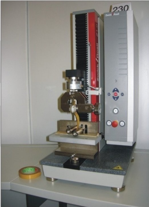
90° soyulma(peel) testi aparatı
