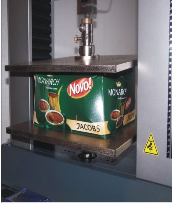
Gıda ambalajı basma testi (box crush test)
