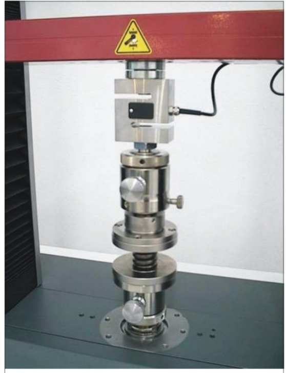
Çevrimli (cyclic) yay basma testi, otomatik olarak yay referans kuvvetleri ve yay sabiti hesaplama
