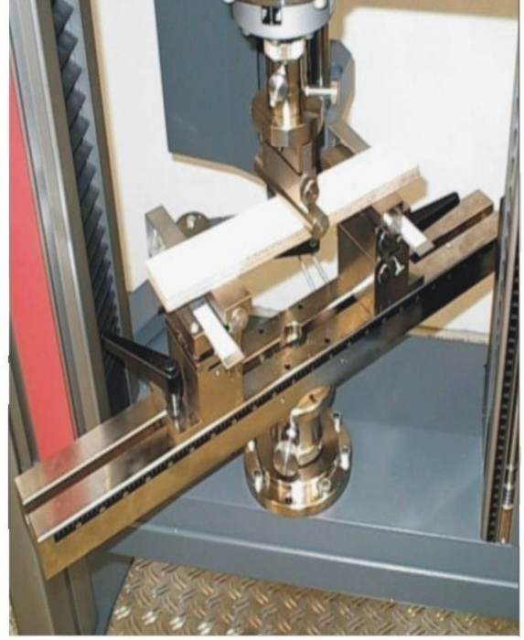
Ahşap numunelerde 3 nokta eğme aparatı
