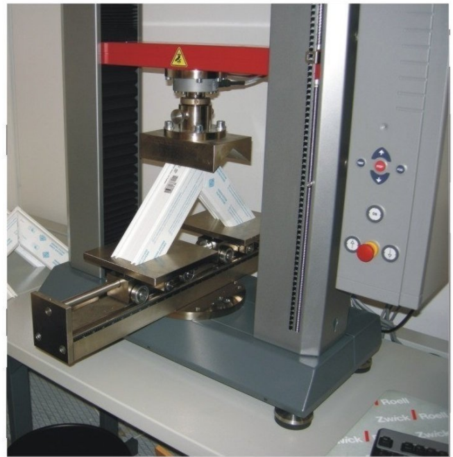
PVC pencere profillerinde köşe kırma aparatı
