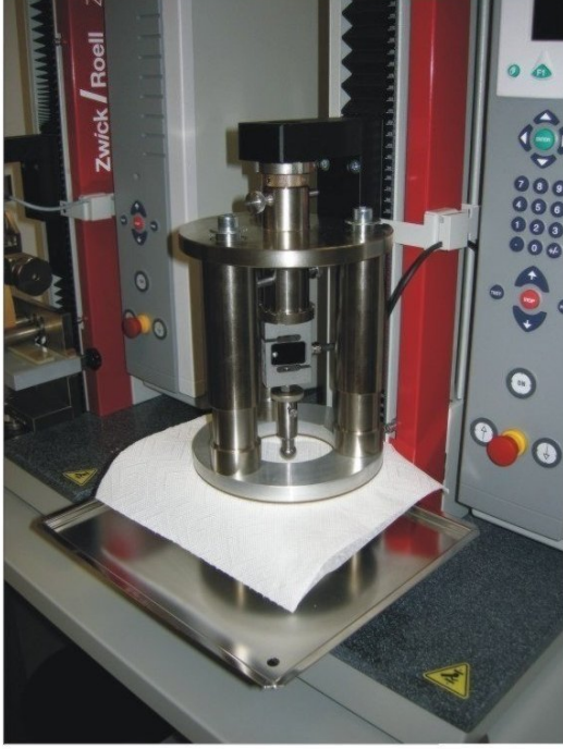
Kağıt patlatma (burst testi) aparatı
